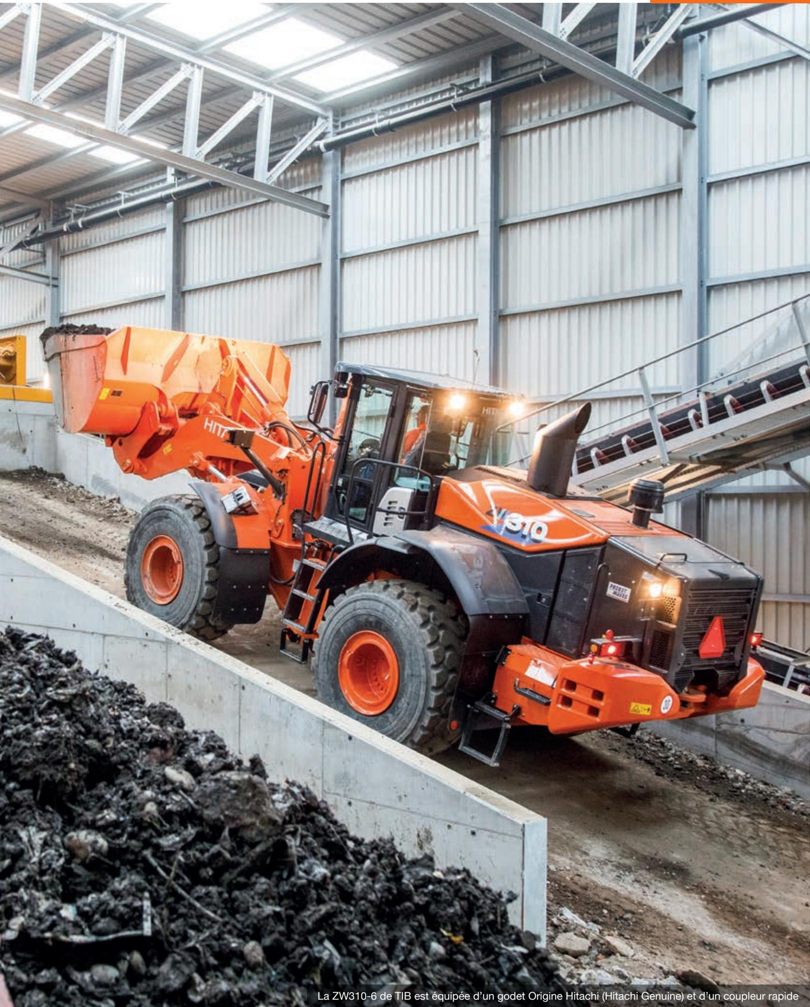
La ZW310-6 de TIB est équipée d'un godet Origine Hitachi (Hitachi Genuine) et d'un coupleur rapide
