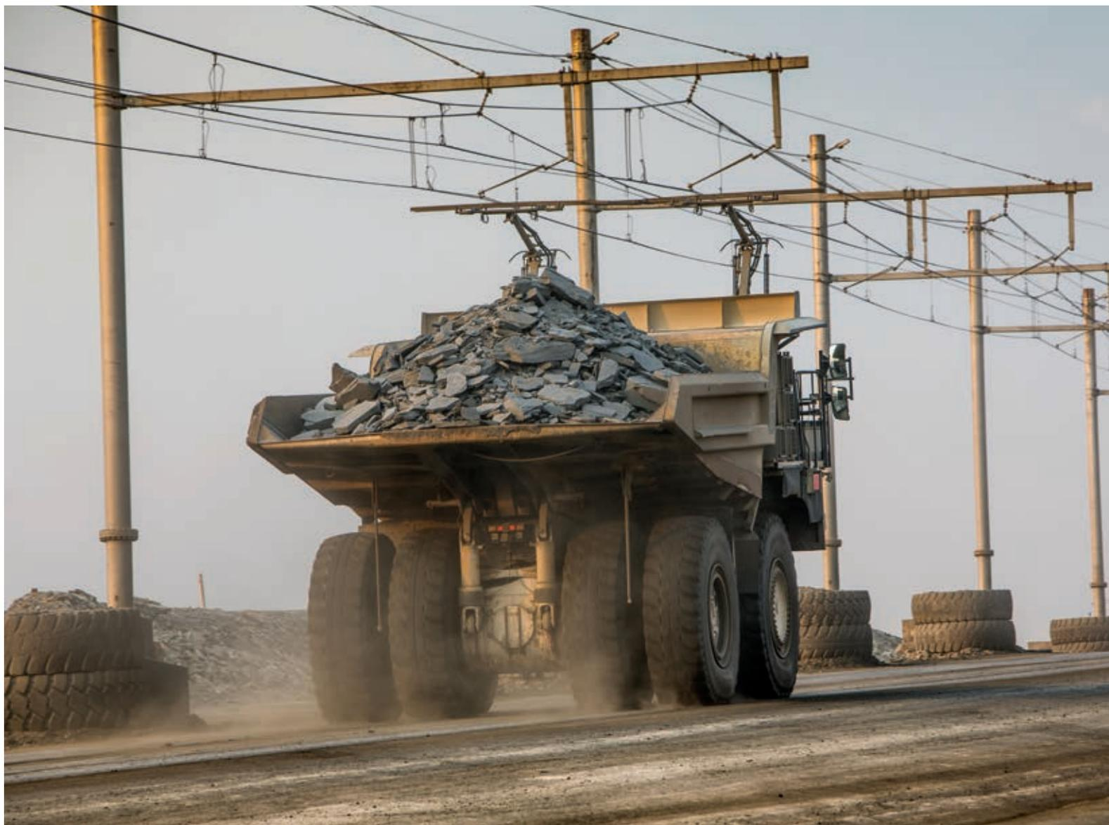
vice versa. La commutation se fait automatiquement à la détection d'un courant électrique entrant. Très souple, ce système réduit les contraintes au niveau du châssis et des roues, limitant ainsi le débordement de matériaux.
