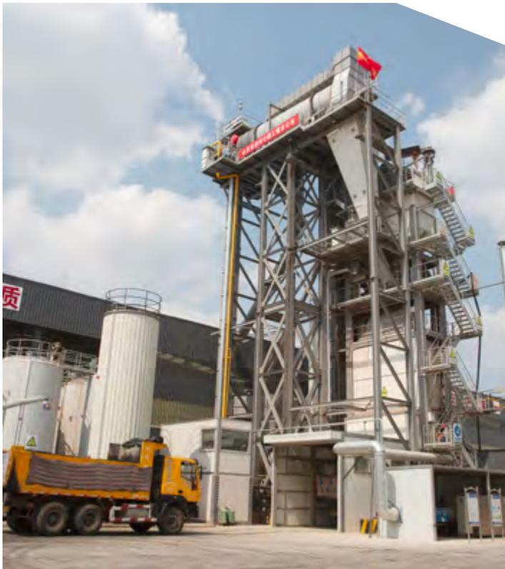
Shandong Binzhou Road Construction Corp. a fait appel au poste d'enrobage Ammann ABA UniBatch pour sa capacité à utiliser du RAP sans baisse de qualité.
