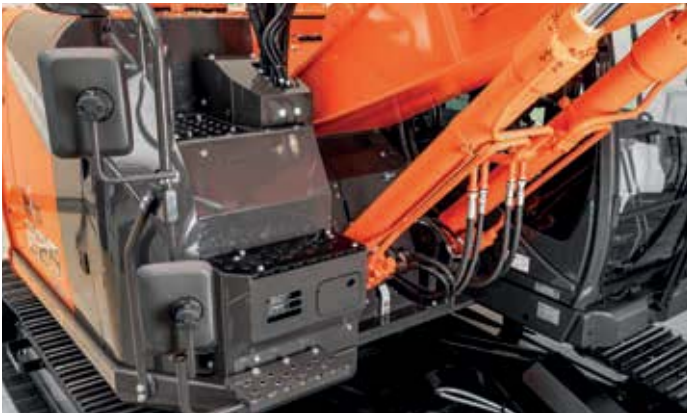
Brede opstappen op de ZX225US/USR-7 vergemakkelijken toegang tot de bovenwagen en daarmee het onderhoud.
