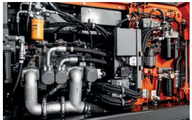
Het TRIAS III hydraulische systeem biedt tot 11 % brandstofbesparing.
