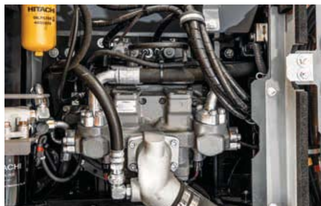
Het HIOS IV hydraulische systeem biedt tot 7 % brandstofbesparing.
