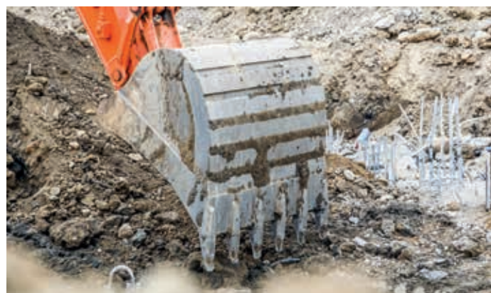
Hitachi-graafwerktuigen omvatten zelfslipende tanden en betrouwbare adapters, zodat ze precies op de machines passen.
