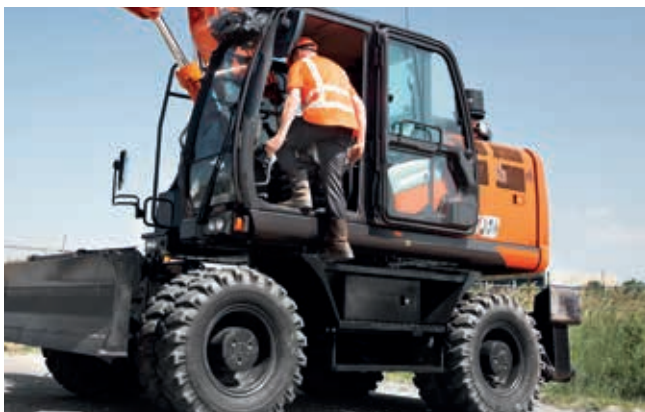
Met de verlaagde onderste trede stapt u veiliger en gemakkelijker in de cabine.
