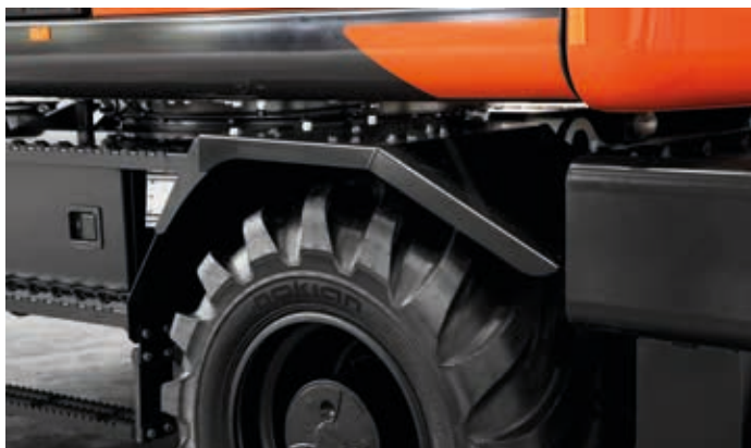
Spatborden op het chassis beschermen de bovenwagen en de lampen tegen opspattend vuil, zodat de machine langer schoon blijft.
