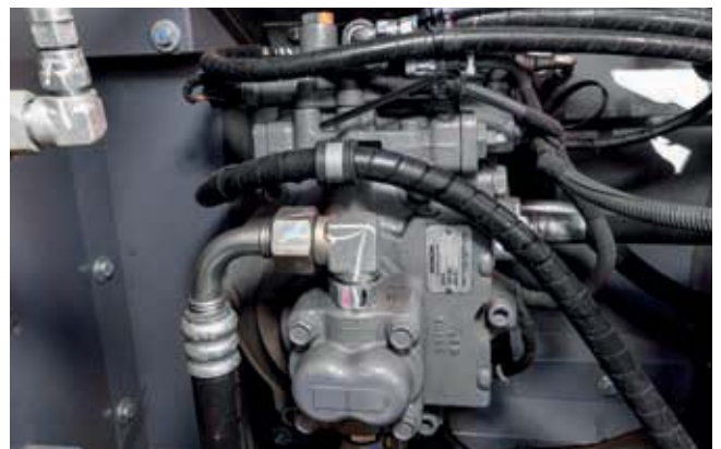
Het HIOS V hydraulische systeem biedt tot 9 % brandstofbesparing.
