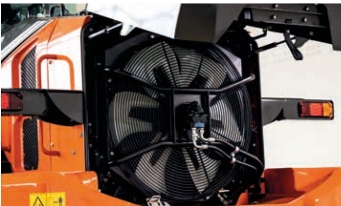
Het slimme regelsysteem van de ventilator voorkomt verstopping van de radiateurs.
