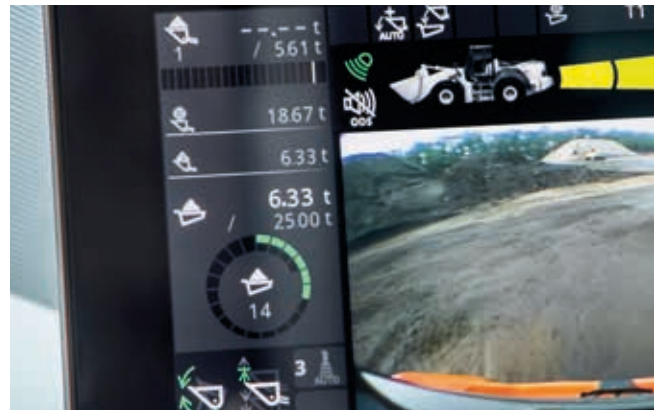
Werk productiever en nauwkeuriger met behulp van het weegstelsel.
