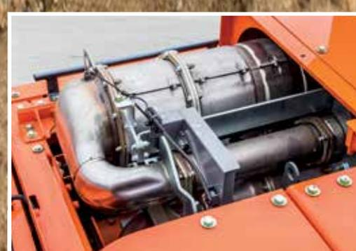
Le système SCR permet de réduire les émissions et les niveaux de bruit.
