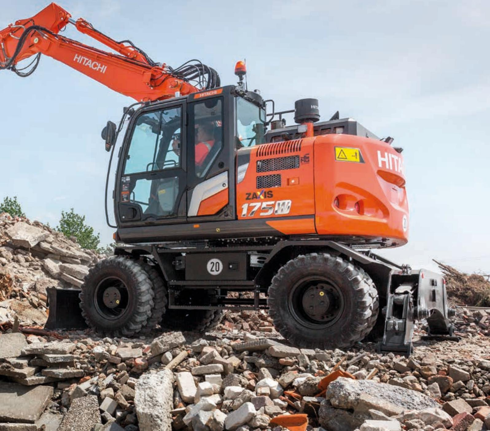
Le système hydraulique HIOS V augmente la vitesse avant et réduit la consommation de carburant.
