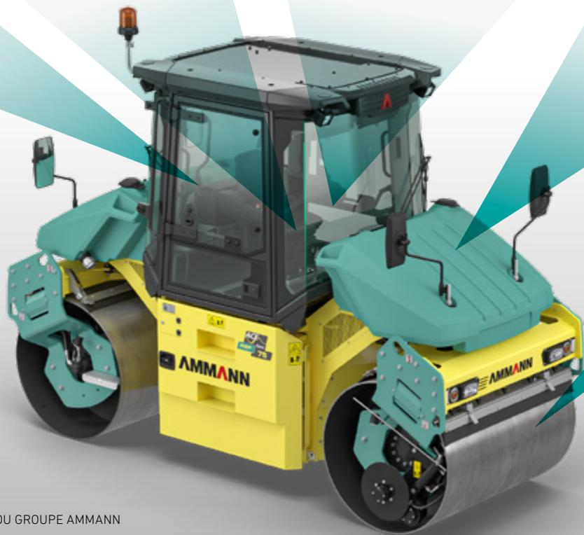
Les compacteurs tandem à châssis articulé ARX 140 et ARX 160 Ammann, d'un poids opérationnel de 16 tonnes, offrent une visibilité à 360° depuis le poste de conduite. Les réservoirs de carburant et d'eau bien conçus et bien positionnés contribuent à améliorer la visibilité sur tous les bords et surfaces de la bille. La largeur de travail de l'ARX 140 et de l'ARX 160 est de 2.130 mm.
